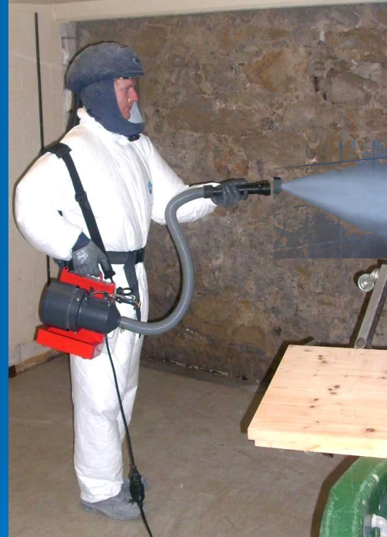
Aerosol-desinfektion mit Kaltnebelgerät
